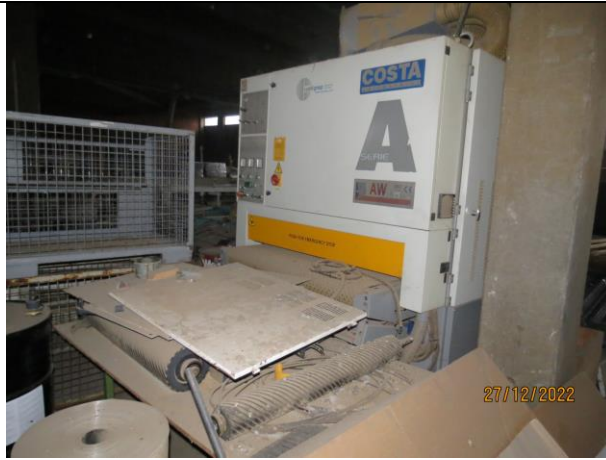
KONTAKTNA BRUSILICA ZA PROFILIRANJE I BRUŠENJE MASIVNIH PLOČA
